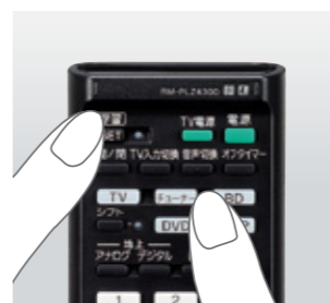
SET ボタンを押したまま、設定したい操作切り換えボタンを2秒以上押す
