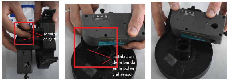
(a) Ajuste del sensor en la base del polarizador con los tornillos de sujeción. (b) Instalación de la banda en los canales de la polea y el polarizador. (c) Aspecto final del montaje.
