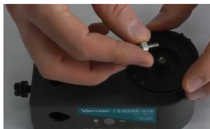
(a) Instalación de polea en sensor de rotación.
