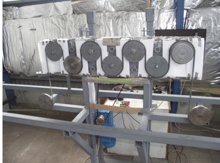
M2. ábra. A héttárcsás vizsgáló berendezés fő tartólemeze a hajtótárcsákkal
