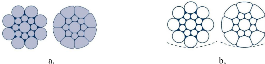
2.7. ábra. Normál kötélszerkezet és a tömörített kötélszerkezet (a.), A normál és a tömörített pászma felfekvése (b.)
