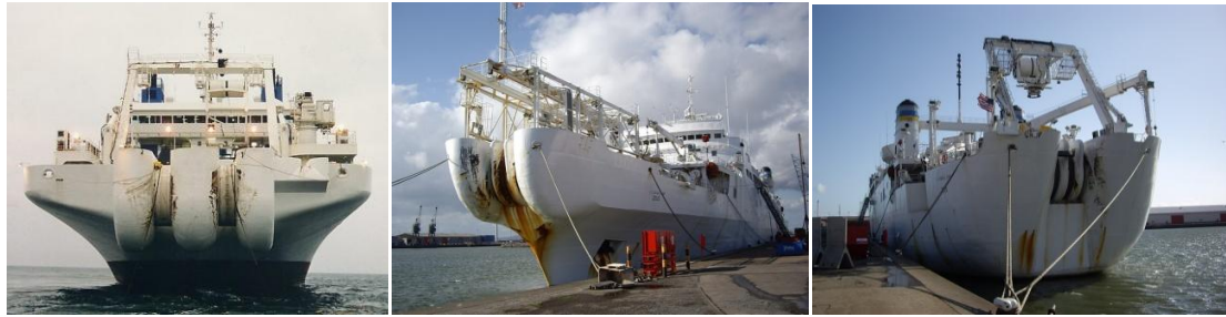
a. b. c. 1.5. ábra. Kábelfektető hajóknál a jellemző orr és far kialakítások
