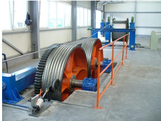
1.3. ábra. Egy szabadvezeték-sodró gépnél használt súrlódó hajtás, [22]
