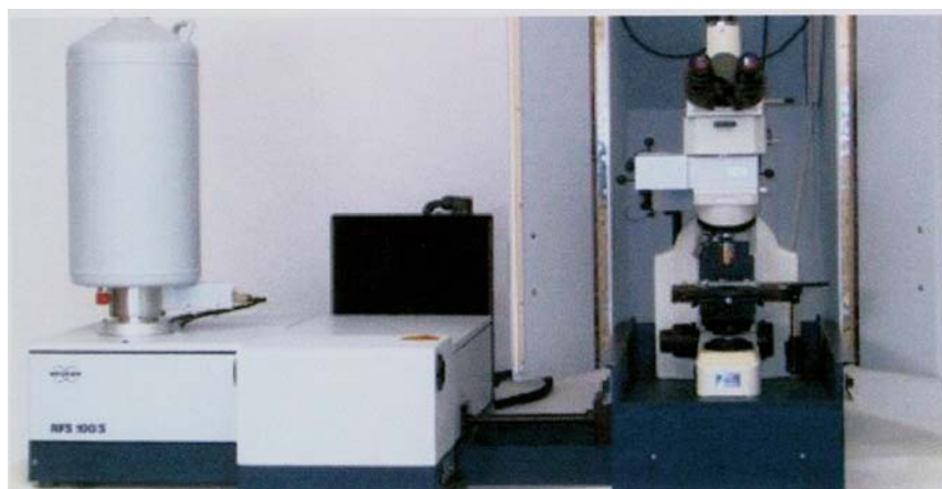
Σχήμα 13.8. Φασματόμετρο Raman και μικροσκόπιο. (Bruker, http://www.brukeroptics.com/raman/images/ramanscopehead.jpg ).
