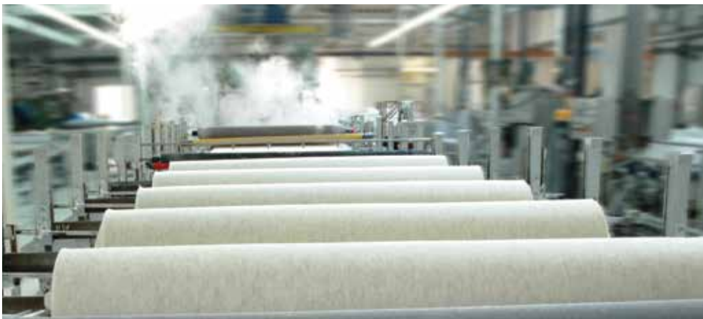
In der Filzmaschine wird unter Druck, Reibung, Wärme und Feuchtigkeit eine Verfestigung der Fasern bewirkt.
