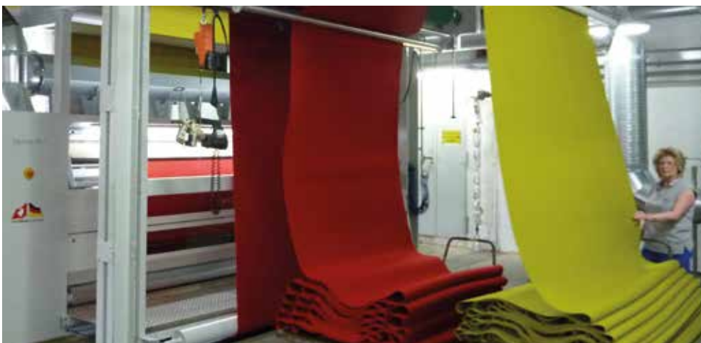
Beim Scheren werden hervorstehende Haare abgeschnitten und das Material erhält eine glatte Oberfläche.
