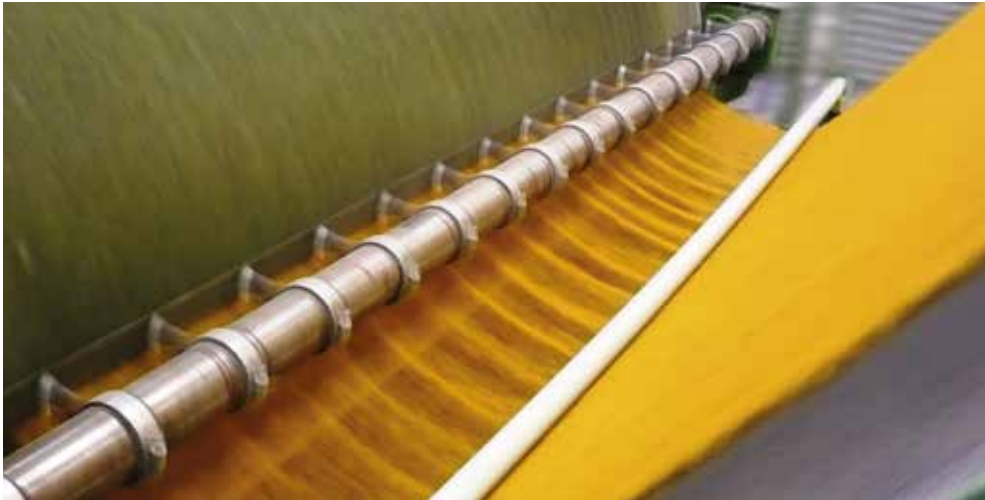
Beim Krempeln wird der Flor verdichtet.
