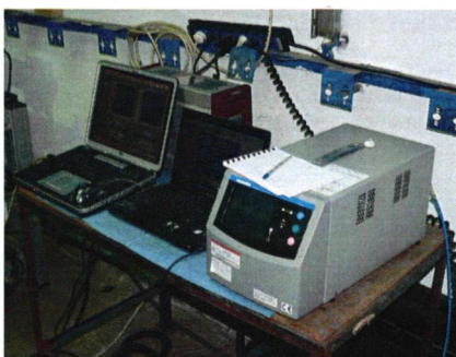
VI. MRU VARIO Plus - analizor de gaze portabil (CnHn,CO,CO2, NOx,H2)
