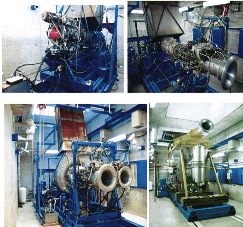
Celula nr.1 de testare-experimentare turbomotoare cu putere la ax
