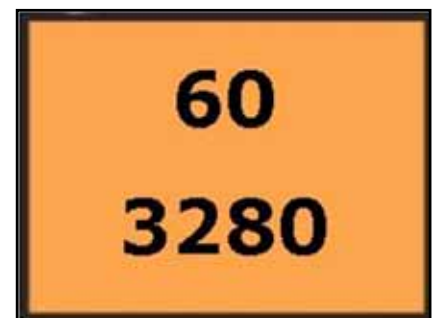
Figura 8: Panel naranja que identifica los riesgos del transporte de materiales tóxicos y que corresponde al transporte de un compuesto órganoarsenical líquido
