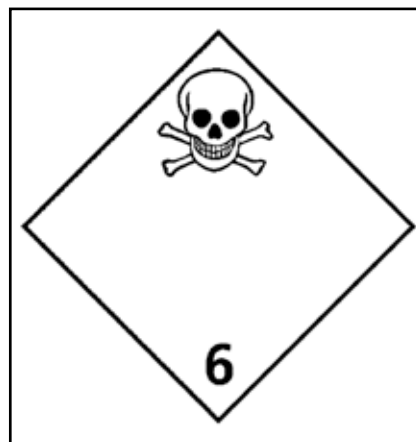
Figura 7: Pictograma que identifica el transporte de materiales tóxicos y que corresponde al transporte de arsénico y sus compuestos, orgánicos e inorgánicos, líquidos o sólidos
