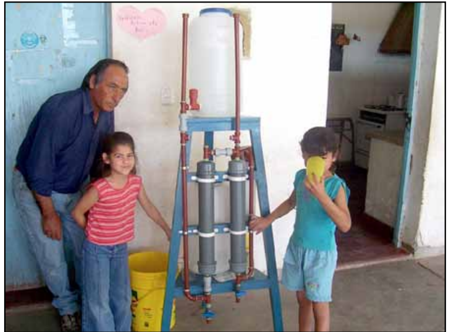
Figura 6: Prototipo para abatimiento de arsénico desarrollado por la Facultad de Ingeniería de la Universidad Nacional de San Juan y montado en la Escuela Dr. Juan Carlos Navarro. Gentileza del Ing. Cáceres.
