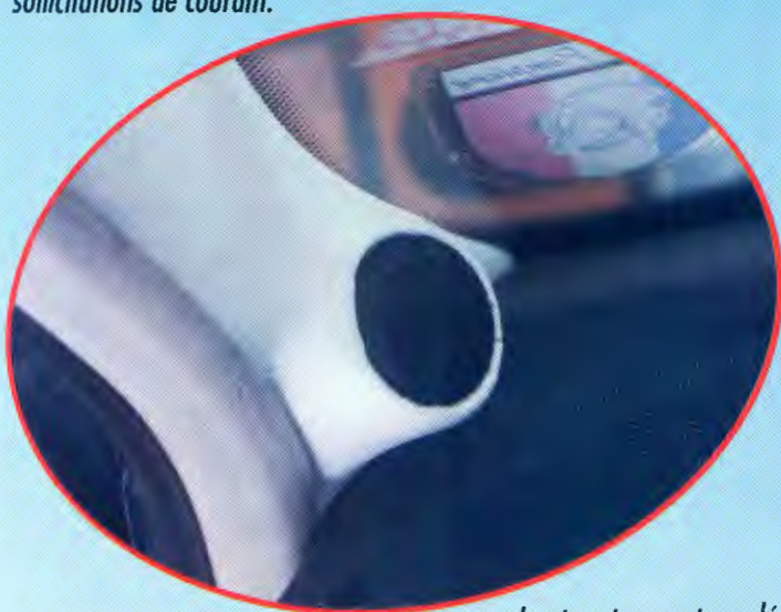
Les tweeters sont moulés dans les montants de pare-brise.
