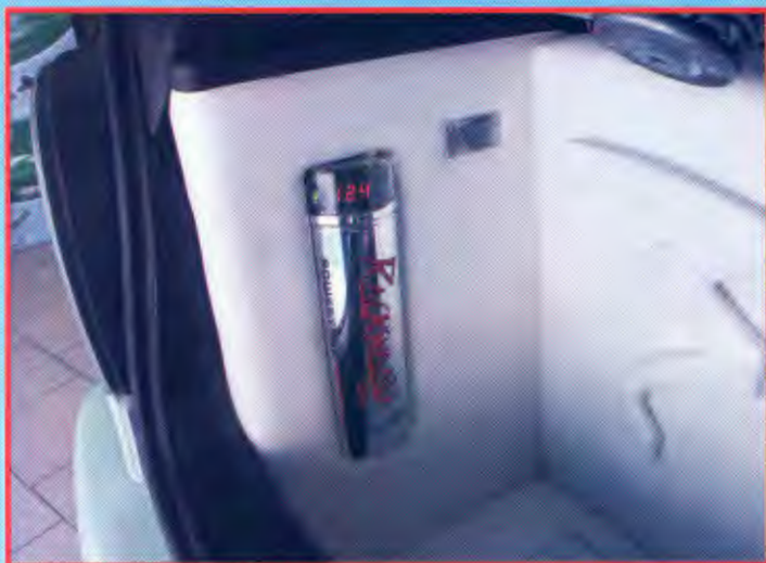
Une capacité Rockwood soutient la batterie lors des fortes sollicitations de courant.
