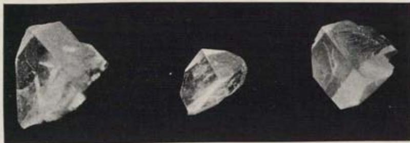
Fig. 3.—Cristales de sulfato magnésico,  $\text{SO}_4\text{Mg} \cdot 7\text{H}_2\text{O}$ , obtenidos en presencia de bórax en la disolución. (Ampliado a doble tamaño.)
