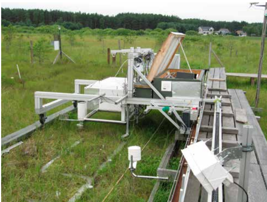
Fot. 87. Automatyczna stacja pomiarowa bilansu gazów cieplarnianych, eksperyment manipulacyjny na Torfowisku Rzezińskim (fot. J. Kujawa-Pawlaczyk).
