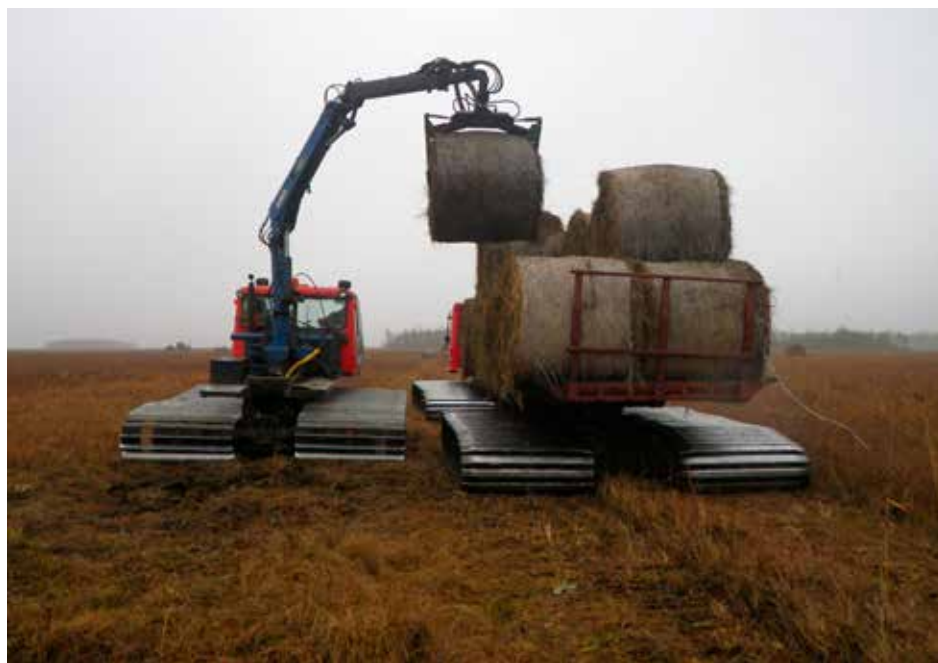
Fot. 111. Sprzęt siana z torfowisk w Biebrzańskim Parku Narodowym przy pomocy ratraka (fot. M. Marczakiewicz).
