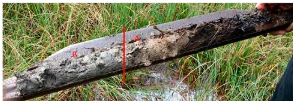
Ryc. 16. Utwory węglanowe – odwiert w młacie górskiej w Magurskim Parku Narodowym. A - torf turzycowy, rozkład 4, B - bezpostaciowa martwica wapienna (fot. D. Horabik).
