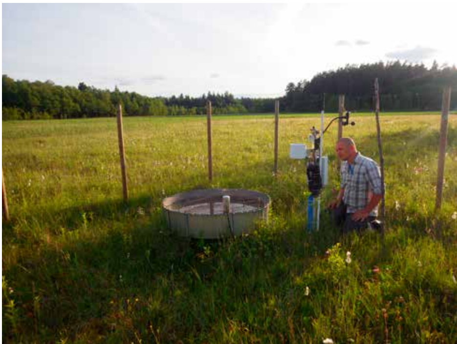
Fot. 130. Stacja pomiarowa z misą ewapotranspiracyjną (fot. E. Gutowska).
