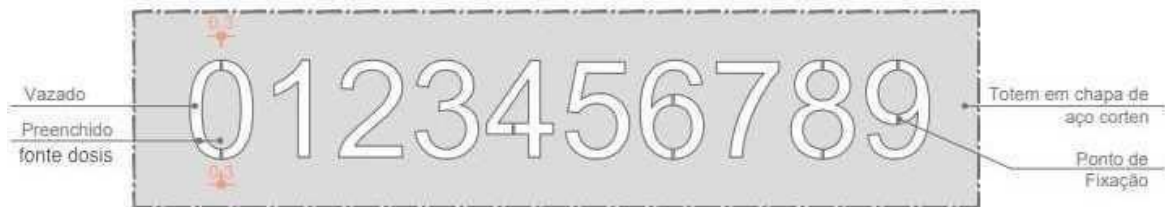
1:10 DETALHE FIXAÇÃO NUMERAÇÃO
