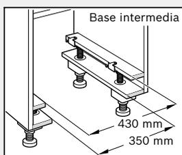
Base intermedia con rejilla inferior (ventilación directa) o sin rejilla inferior (ventilación indirecta).
