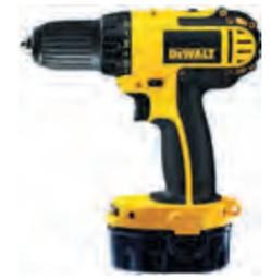
Berbequim/aparafusador de 14,4 Volts para operações de furar e aparafusar Bucha de aperto rápido 13mm de 1 anel com travamento automático do veio Controlo de torque com 17 posições para garantir resultados uniformes e grande precisão em operações de aparafusamento
