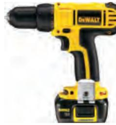
Berbequim/aparafusador de 14,4 Volts para operações de furar e aparafusar Bucha 10mm de aperto rápido de anel único com travamento automático do veio 2 velocidades variáveis e reversibilidade para maior versatilidade e controlo Controlo de torque com 14 posições para garantir resultados uniformes e grande precisão em operações de aparafusamento
