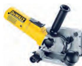
Para além da função de colocação de lamelas, permite igualmente efectuar rasgos. As marcas-guia existentes na base e o ajuste micrométrico permitem uma operação de extrema precisão. As juntas a 45° são fáceis de executar graças à paralela especial fornecida. Controlo preciso, especialmente útil no início e final de uma ranhura.
