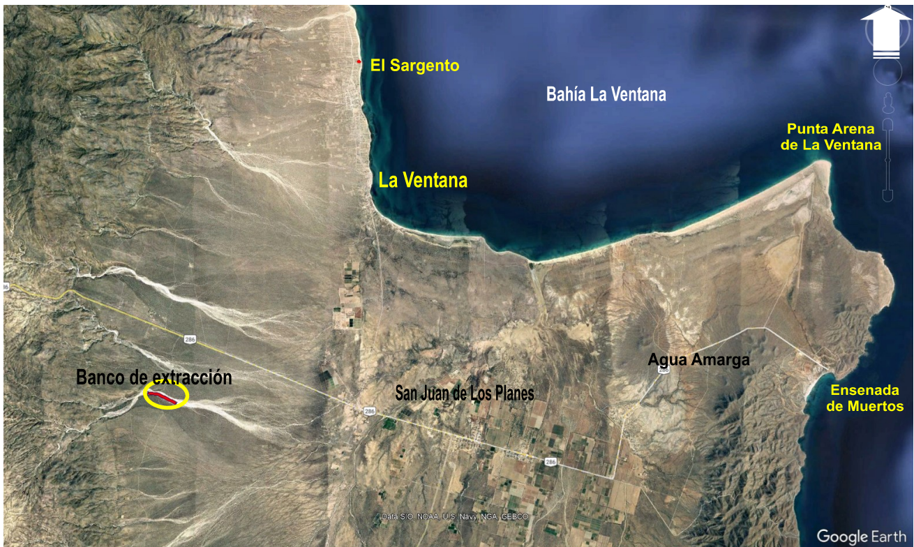
Figura 3.- El polígono en rojo indica la superficie que se solicita para su explotación, la formación del cauce piloto puede ayudar a reducir los riesgos por inundación en algunas zonas adyacentes.
