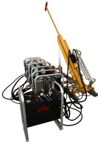
Fotografía 1. Perforadora tipo EGD III.
