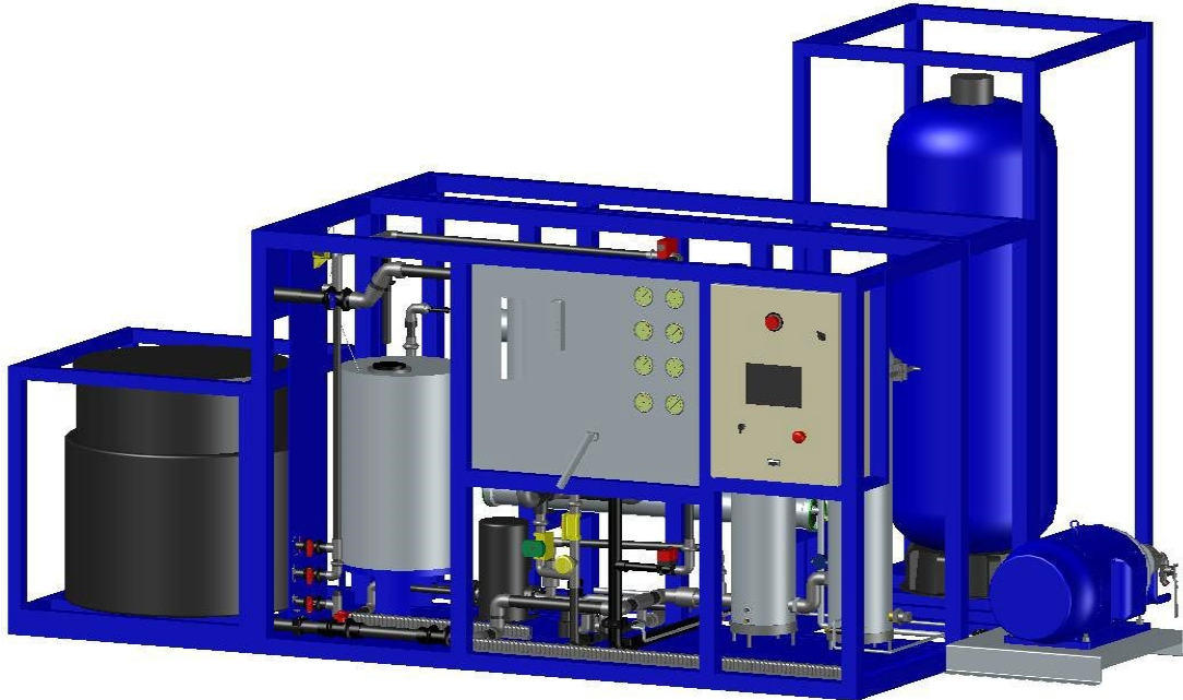
Fig. 3 Patín en donde se encuentra la planta potabilizadora
