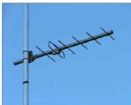
Yagi UHF excitada por un dipolo plegado con reflector simple
