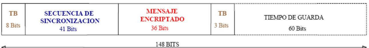
**Fig 2.1.7 Estructura de una ráfaga de acceso de 148 bits**
