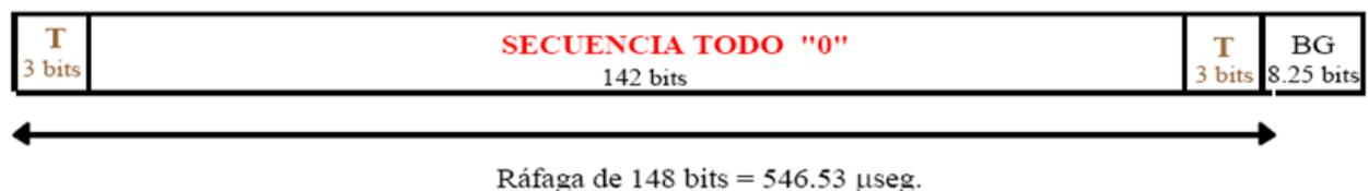
**Fig 2.1.5 Estructura de una ráfaga de corrección de frecuencia de 148 bits**
