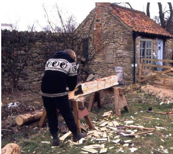
*Herstellung eines Balkens aus einem kurzen Rundholz mit Schrotaxt und Breitbeil durch Einkerbten, Abschwarzen und Beschlagen. Die Umrissse des künftigen Balkens wurden vorher auf das Rundholz mit Bleistift und Schlagschnur angerissen.*
