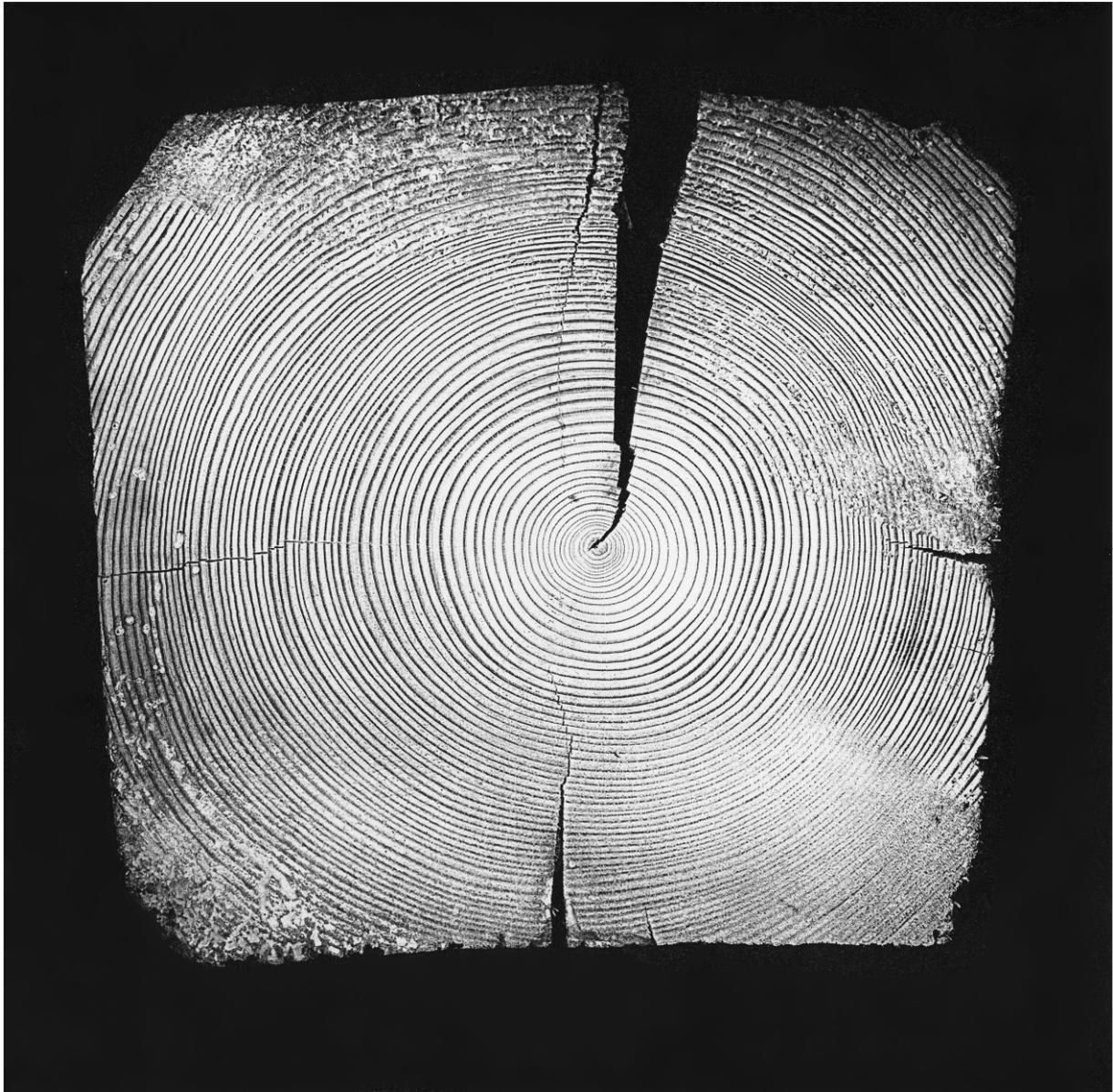
*Querschnitt durch einen Nadelholzbalken mit Schwundrissen, die bis zum Kern reichen, und aufgewölbten Oberflächen.*
