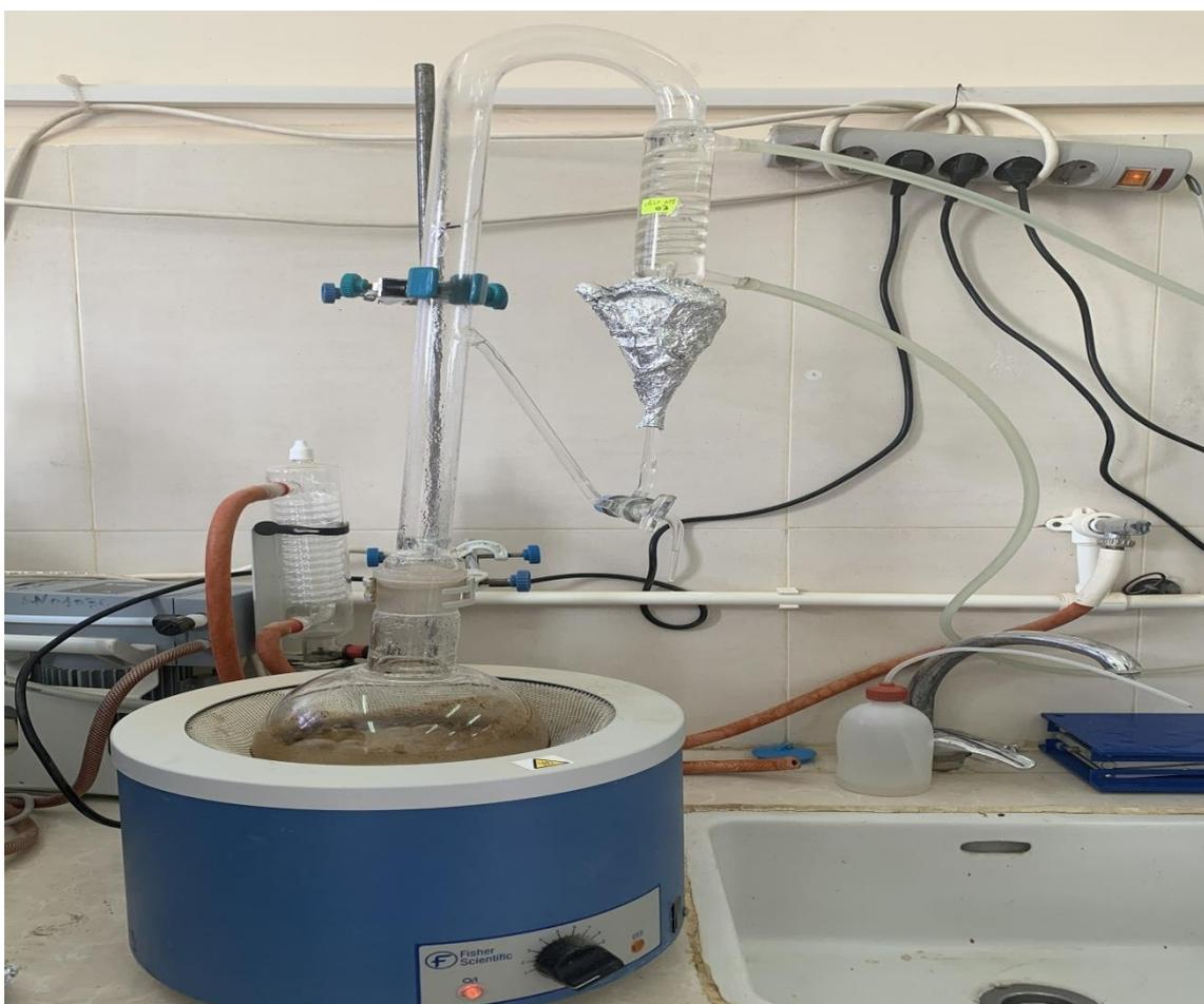
**Figure 5.** Appareil de type Clevenger utilisé pour extraire les huiles essentielles des graines de *B. incrassatum*.
