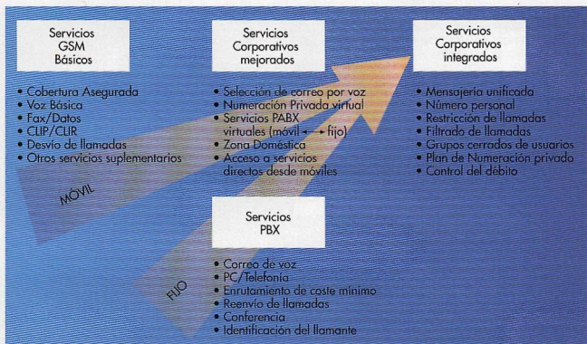
Figura 6 - Convergencia de las tecnologías de comunicaciones móviles y fijas en una única red virtual
