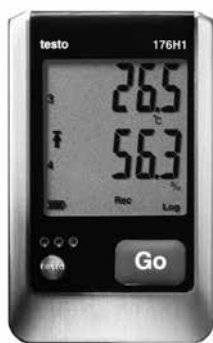
Дигитални даталогер за температуру и влажност
