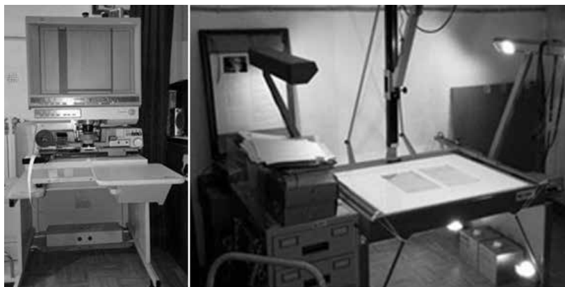
MS 7000 MK2 Konica Minolta čitač mikrofilma i Hirakawa 35 mm ručna kamera za mikrofilmovanje u Arhivu Bosne i Hercegovine
