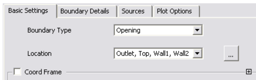
Εικόνα 4.7: Λεπτομέρειες ορισμού της οριακής συνθήκης "Opening" στις αντίστοιχες επιφάνειες του υπολογιστικού χωρίου
