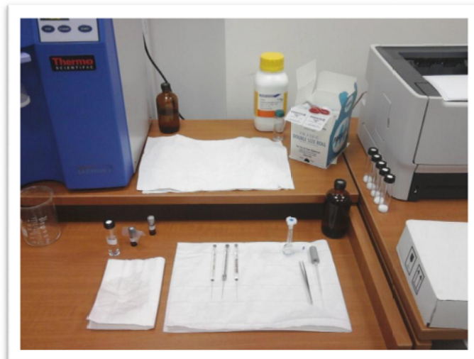
Εικόνα Π.4: Υλικά και εργαλεία που χρησιμοποιήθηκαν για την παρασκευή των δειγμάτων κινητικής και ισορροπίας της προσρόφησης
