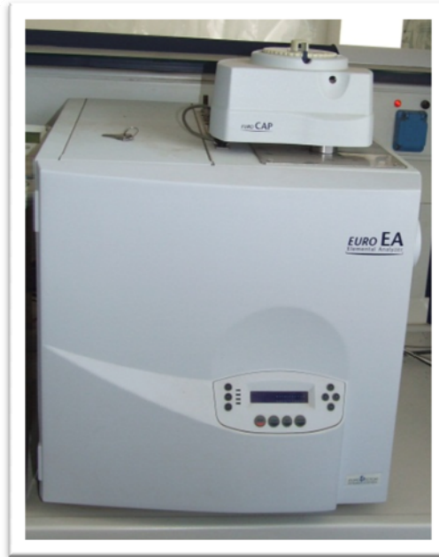
Εικόνα Π.1: Στοιχειακός αναλυτής CHNS-O EA3000 (EuroVector)
