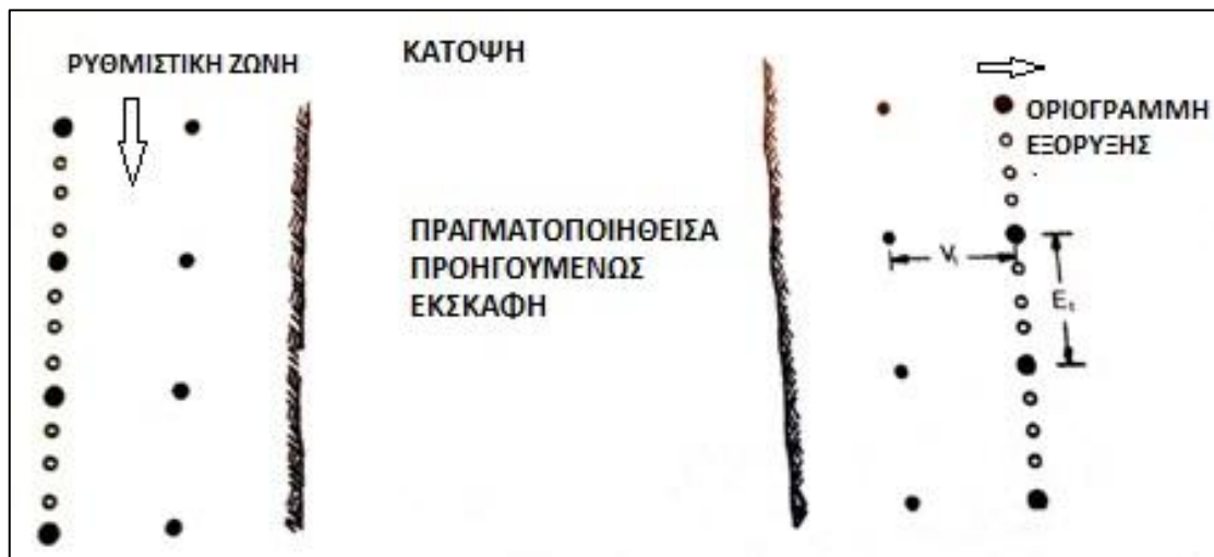
Σχήμα 4.14: Διατάξεις διατρημάτων μεθόδου απαλής ανατίναξης (Πολυχρονόπουλος, 2001).
