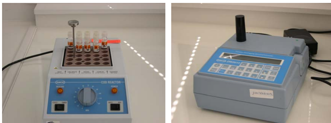
Εικόνα 3: (α) χωνευτήρας COD και (β) φασματοφωτόμετρο, για τη μέτρηση του COD.
