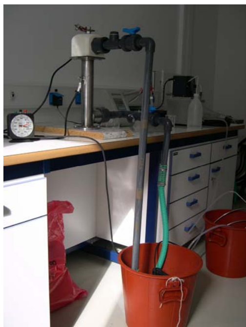
Εικόνα 2: Φωτογραφία (α) της διάταξης ηλεκτρόλυσης και (β) του ηλεκτρολυτικού κελιού που χρησιμοποιήθηκε.
