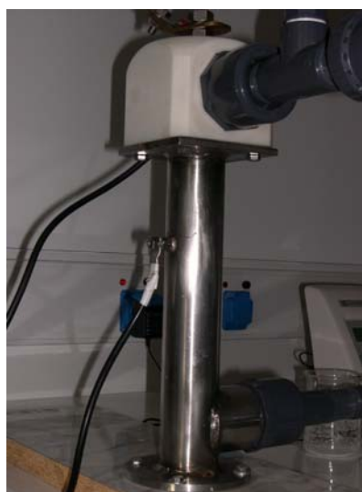
Εικόνα 2: Φωτογραφία (α) της διάταξης ηλεκτρόλυσης και (β) του ηλεκτρολυτικού κελιού που χρησιμοποιήθηκε.
