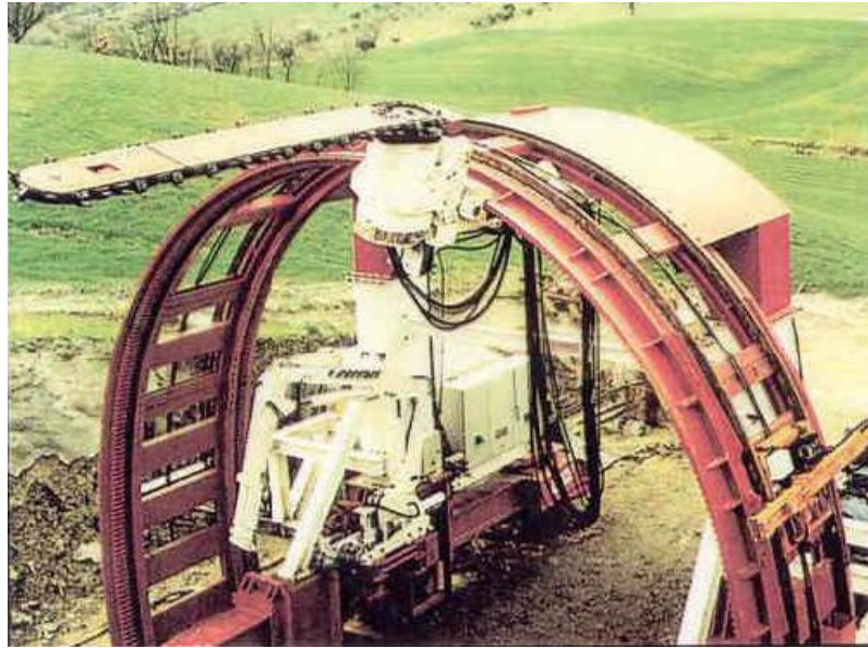
Σχήμα 2.29 Μηχάνημα περιφερειακής πρότμησης (Βιόπουλος, 2006 από Peila et al , 2006)
