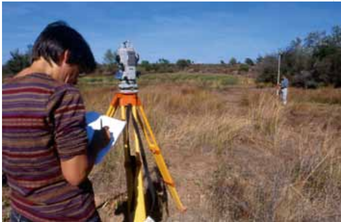
Étude topographique préalable à la restauration hydraulique (mare de Péguière)
