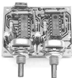
B 122* Stereo-Verstärker max. 2x 2.5 Watt Versorgungsspannung 6-12VDC Eingangsempfindlichkeit ca. 100mV Ausgangsleistung max. 2x 2.5W Frequenzgang ca. 20Hz-20kHz für Lautsprecher 8-16 Ohm jeder Kanal ist einzeln regelbar, IC's sind gegen kurzzeitige Überlastung geschützt
