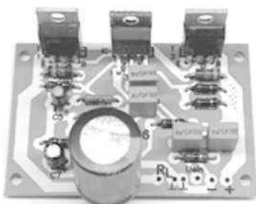
B 086* Verstärker 80 Watt Versorgungsspannung 24-40VDC Eingangsempfindlichkeit ca. 500mV Frequenzgang ca. 20Hz-20kHz für Lautsprecher 4-16 Ohm zum Betrieb ist ein Kühlkörper mit 2K/W (mind. 150x 50x 30mm) erforderlich
