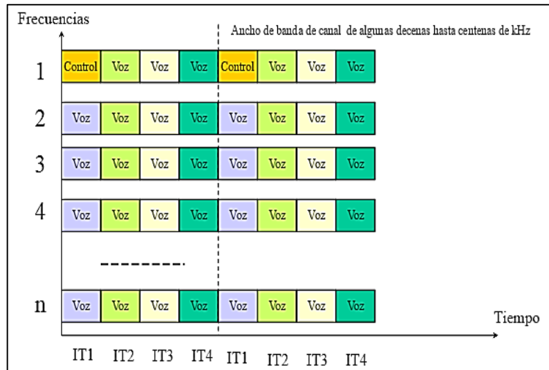
Figura 1. Estructura canal TDMA
