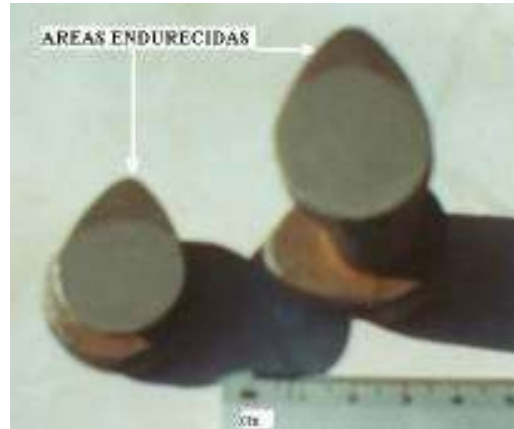
Figura 3.36 Secciones del árbol de levas que muestran el perfil de temple en la “cresta” de la leva.
