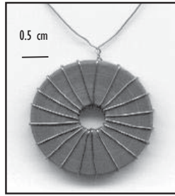
Figura 2.13. Geometría de la muestra para practicar el ensayo de permeabilidad magnética, mostrando el embobinado realizado.
