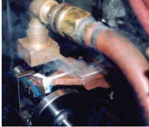
Figura 2.17.- Montaje de los concentradores de energía magnética en la periferia de la bobina inductora en el momento del calentamiento.
