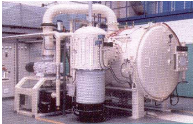
Figura 2.11.- Horno de vacío ABBAR utilizado en el sinterizado
