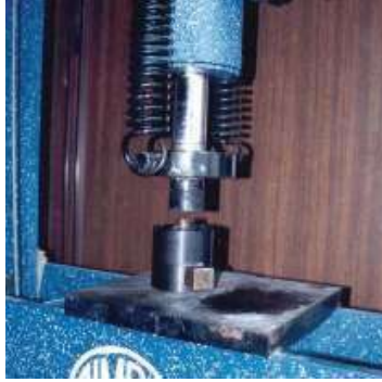
Figura 2.9 Prensa y dado empleados en la compactación de las muestras.
