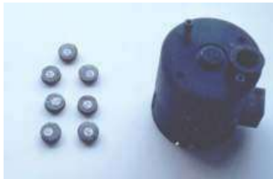
Figura 2.10.- Muestras “en verde” obtenidas después del compactado en el troquel mostrado.
