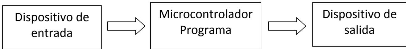
Figura 2.8 Sistema microcontrolado.
