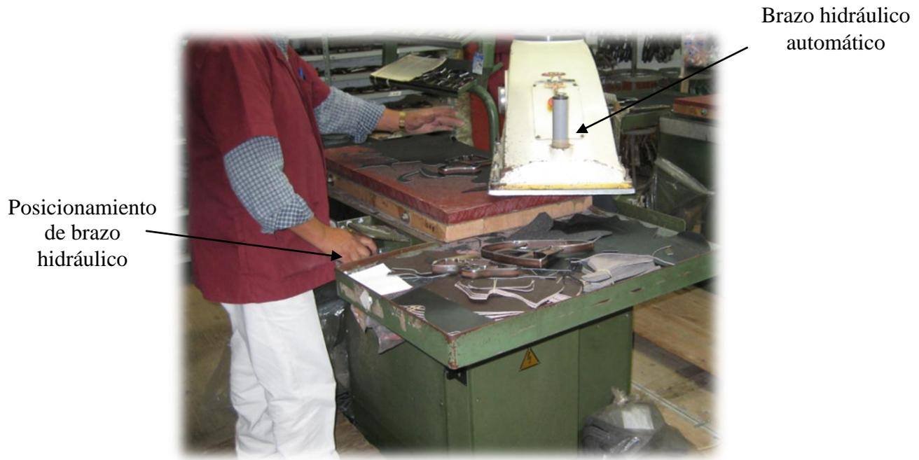
Figura 2.4 Máquina suajadora hidráulica semiautomática.
