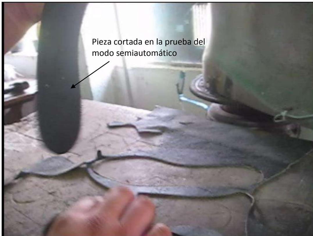
Figura 4.8 Prueba utilizando el modo semiautomático realizando el corte de la piel.
