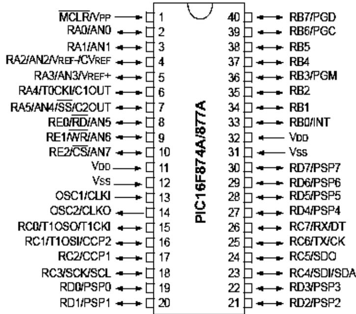
Figura 2.9 Diagrama de un Microcontrolador.
