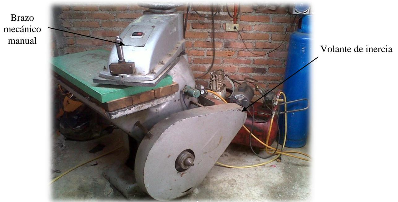
Figura 2.2. Máquina suajadora mecánica con brazo manual.
