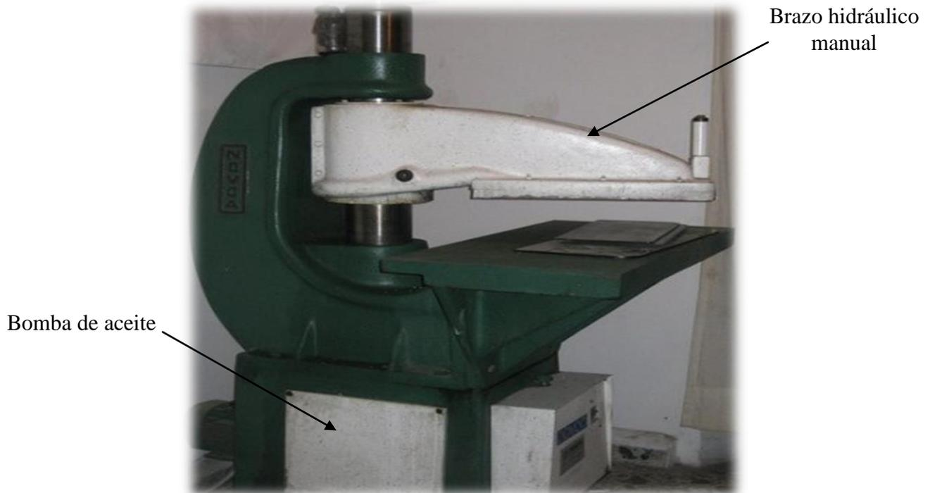
Figura 2.3 Máquina suajadora hidráulica con brazo manual.
