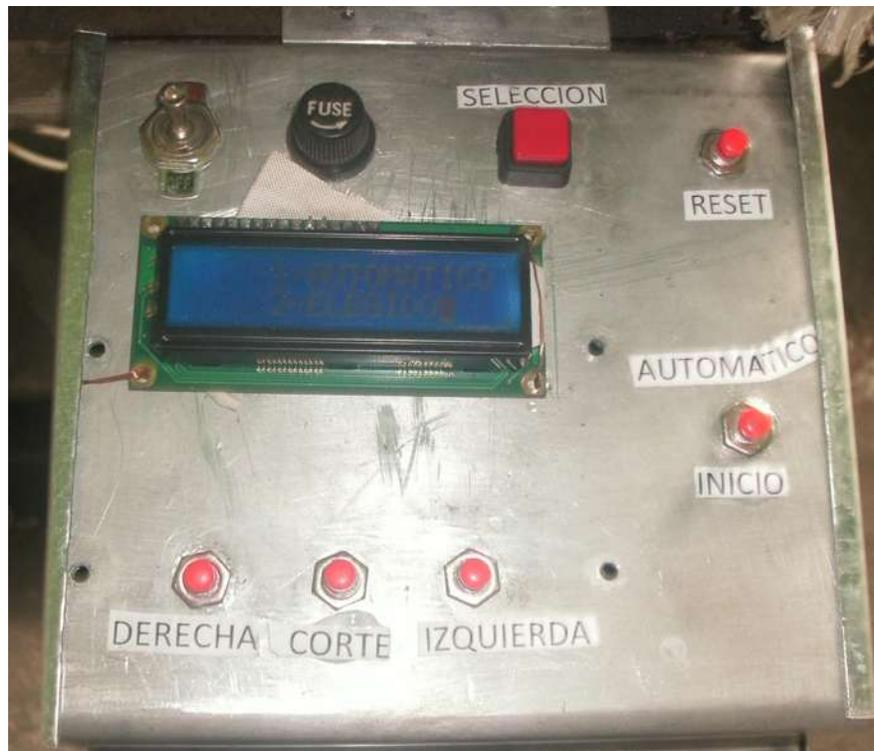
Figura 4.1 Circuito de control de la máquina suajadora
