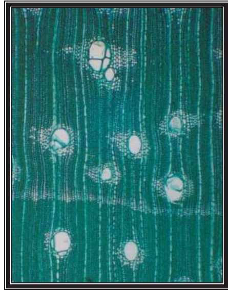
Fig. 29. Tipos de parénquima leñoso en corte transversal. (4x)
