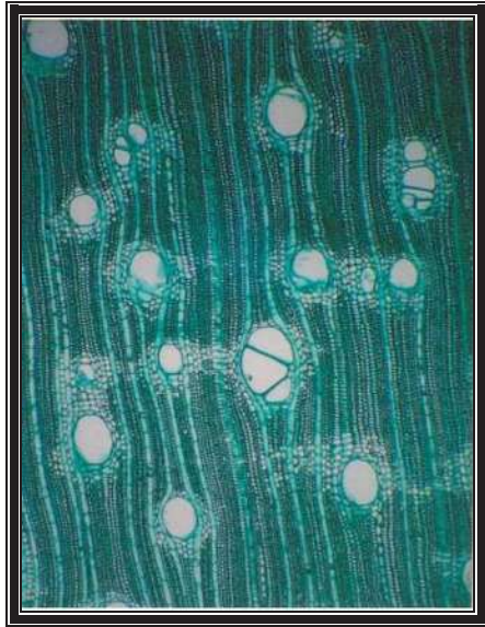
Fig. 29. Tipos de parénquima leñoso en corte transversal. (4x)
