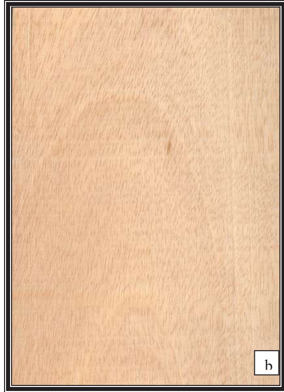
Fig. 35. Diferencias en la textura; a) albura; b) cercana a la medula
