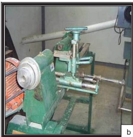
Fig. 20. Equipo utilizado para el ensayo de torneado a) torno de bancada abierta; b) Porta cuchilla; c) Cuchilla empleada
