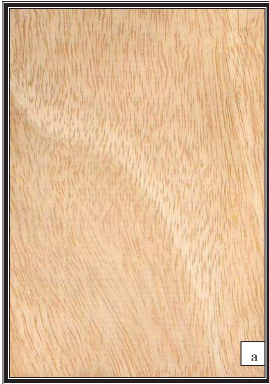
Fig. 35. Diferencias en la textura; a) albura; b) cercana a la medula
