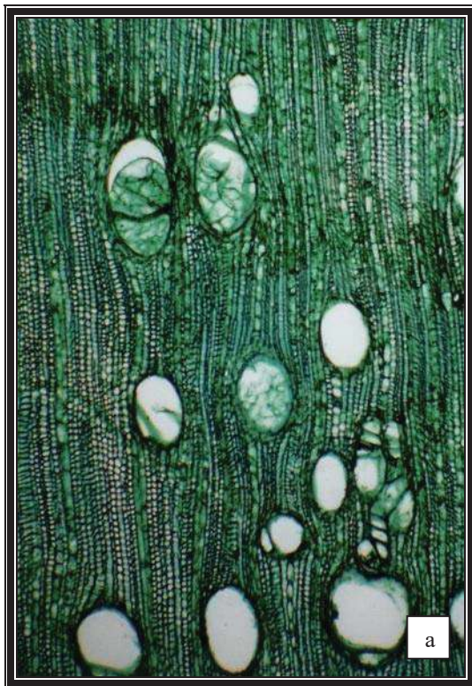
Fig. 36 diferencia en diámetro de poros; a) albura; b) cercana a la médula
