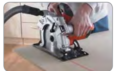
Staubsaugeranschluss für ein sauberes Arbeitsumfeld und Sicherheitsschalter rechts und links.
