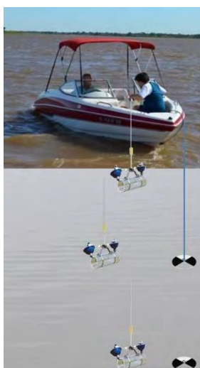
Figura 117. Muestreo para análisis cuantitativo de plancton mediante botella tipo Van Dorn, a diferentes profundidades de la columna de agua.
