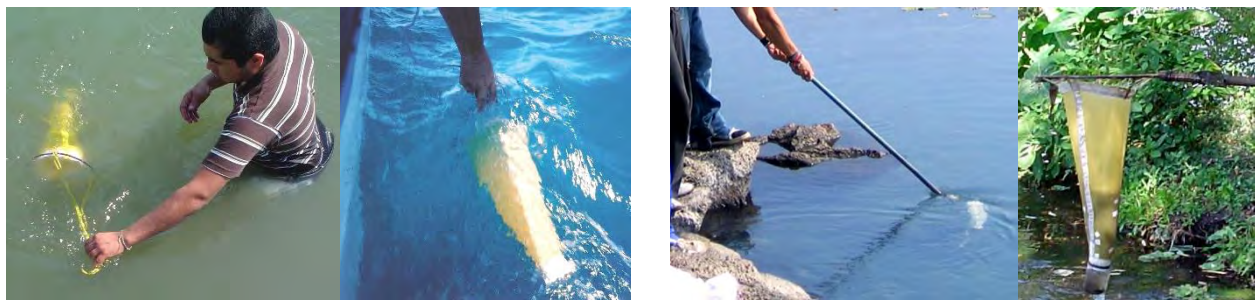
Figura 129. Muestreo por arrastre en sistemas someros, izquierda con red cónica de arrastre y derecha con red de cuchara.
