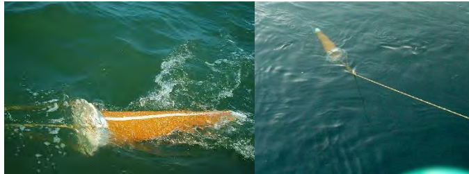
Figura 125. Redes de aro estándar para colecta horizontal, se muestra una red cónica con abertura de malla aproximadamente de 39.0 \mu\text{m} y una longitud de 150 cm, con un aro mayor de abertura de 50 cm de diámetro.
