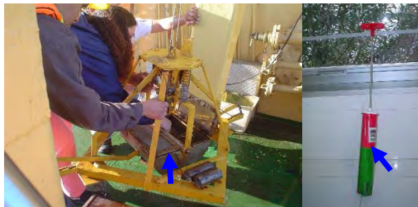
Figura 131. Colectores para protistas epipsámicos, izquierda draga Petersen y derecha nucleador cilíndrico.
