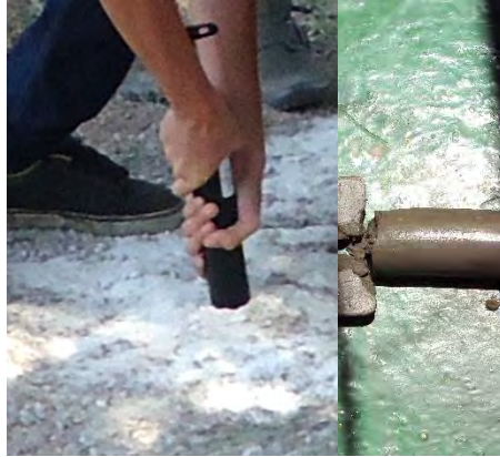
Figura 139. Izquierda obtención de núcleo, derecha barra de núcleo fresca.
