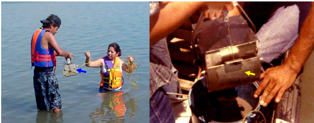
Figura 140. Obtención de sedimentos blandos de zonas menores a tres metros de profundidad por medio de una draga tipo Ekman.
