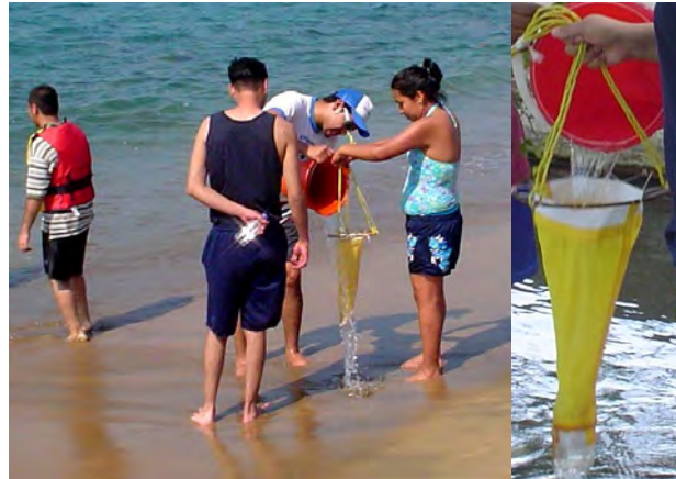
Figura 128. Muestreo estacionario, red cónica para arrastre con una longitud aproximada de 50 cm, aro mayor de 25 cm y una abertura de malla más o menos
