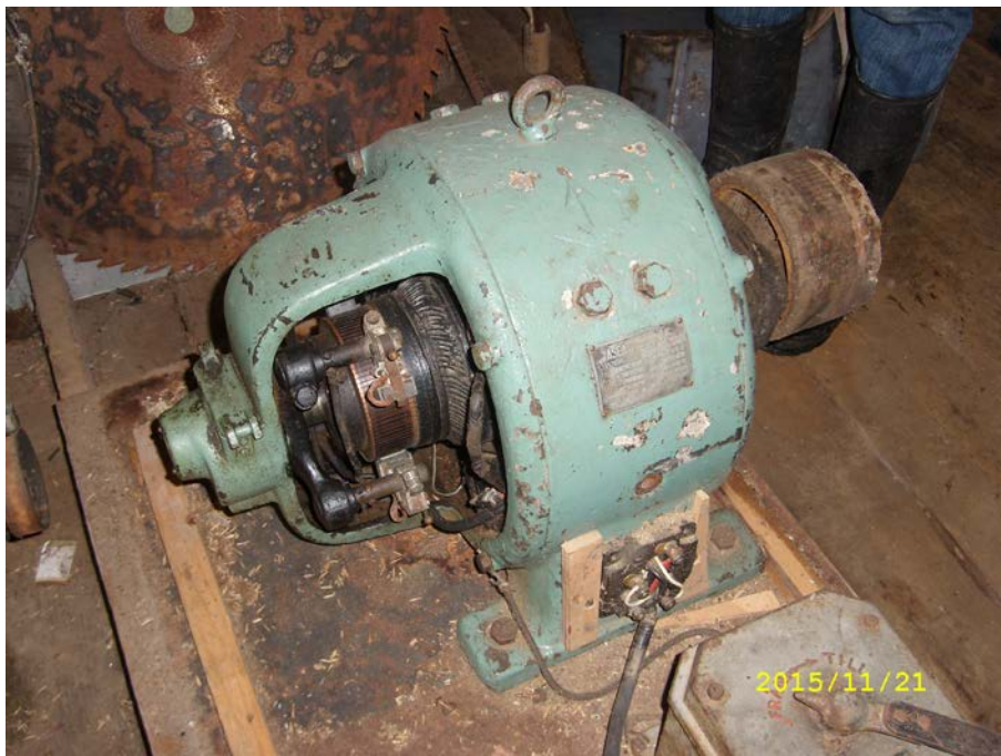
Figur 18 Bevarad likströmsmotor med pådragsanordning i Stensjö Kvarnagård.
