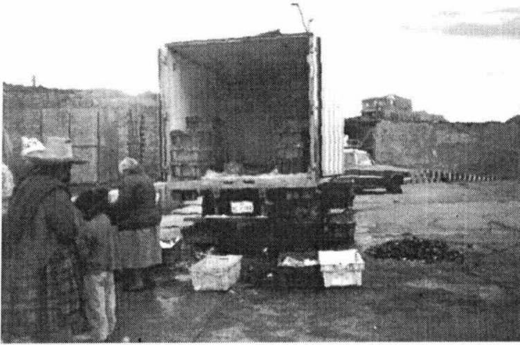
Foto 6: Cámara Isotérmica - Transporte de Pescado Fresco
