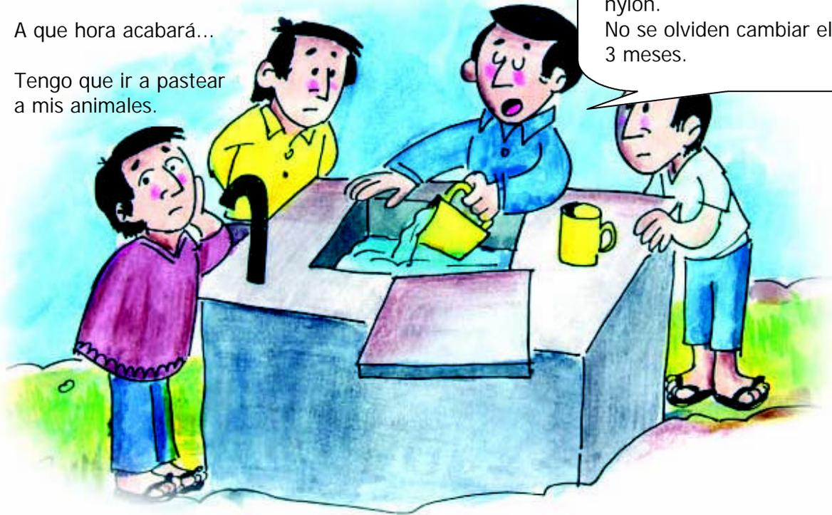
Para este caso se coloca 2 Kg de cloro en el hipoclorador, se tapa y se asegura con una cuerda de nylon.
