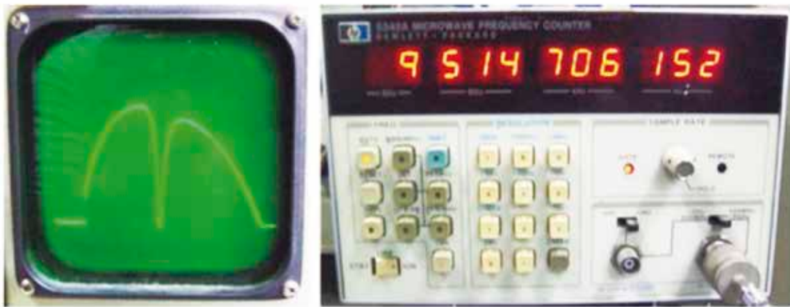
Figura 4.6 Izquierda: Patrón de modo del klistrón observado en la pantalla del módulo del osciloscopio E-200A, después de la calibración del puente de microondas E-102. Se observa el “deep” de la cavidad rectangular E-231 sin muestra, centrado en el modo de oscilación del klistrón, lo cual indica una sintonización óptima del puente a la frecuencia de resonancia de la cavidad.
