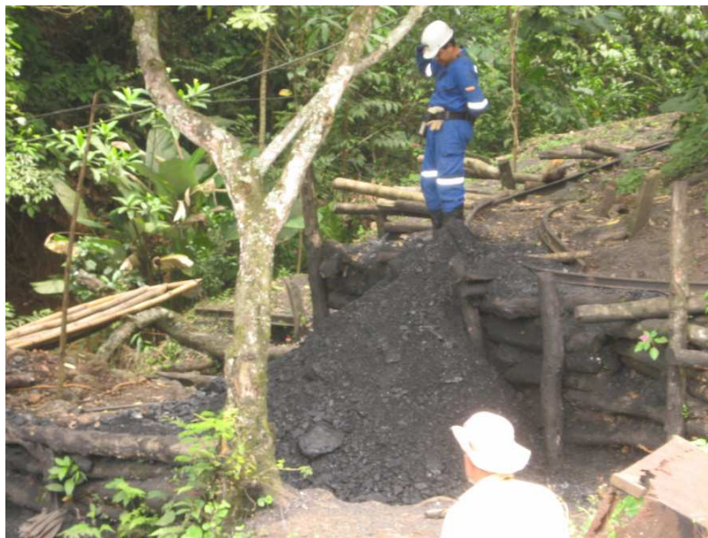
Figura 14. Patio de Acopio y Cargue de Carbón .
