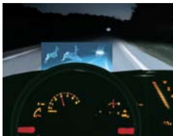
Als een jetpiloot: met behulp van LED-infraroodsensoren wordt veiligheidsrelevante informatie geprojecteerd op de autovoorraut.
