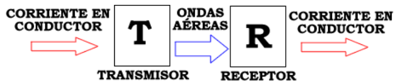
Figura 3.1 Diagrama a bloques de un sistema genérico de comunicación inalámbrica.
