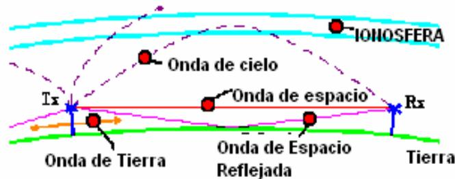
Figura 1.1 Propagación de las Ondas de Radio.
