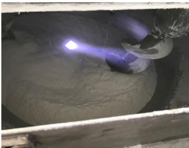
图6 试生产工艺加入AEO<sub>9</sub>后粉体状态
