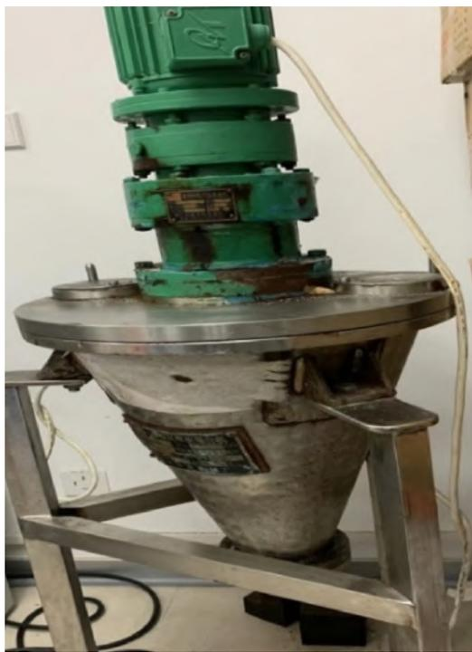
图5 实验室锥形双螺旋设备
