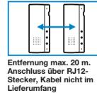
Entfernung max. 20 m. Anschluss über RJ12-Stecker, Kabel nicht im Lieferumfang
