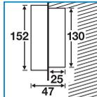
Abmessungen Außen- gerät UP (AP als Zubehör)
