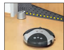
„Virtuelle Wand“ durch Infrarot-Sensor
