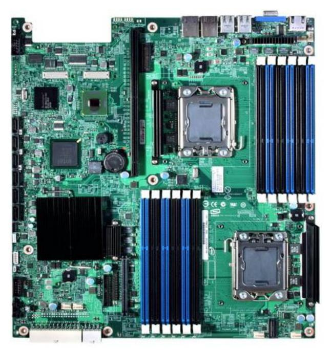
Figure 4. Intel<sup>®</sup> Server Board S5520UR
