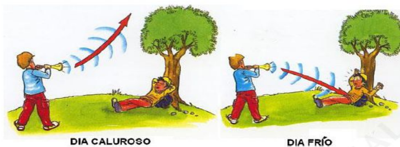
La imagen muestra la refracción del sonido en un día caluroso y en un día frío. Observe cómo se desvía el sonido debido a la posición de las capas de aire según la temperatura ambiental.
