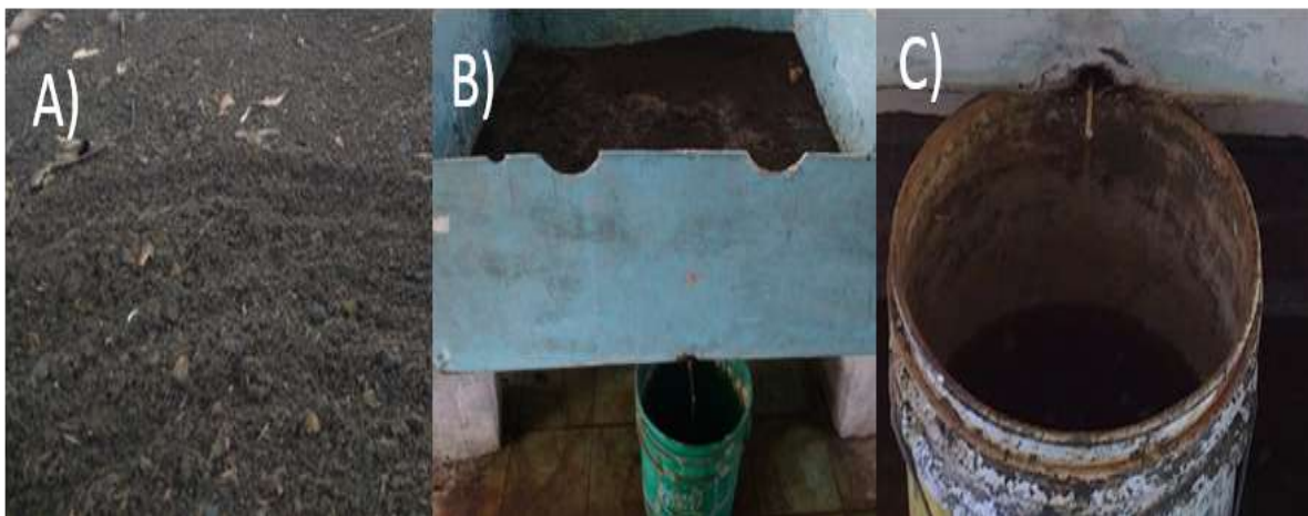
Figura 3. A) Materia orgánica cruda que funciona de alimento para las lombrices californianas, B) y C) Tina de lombricompostaje, 1er. y 2.do recolector de lixiviados.
