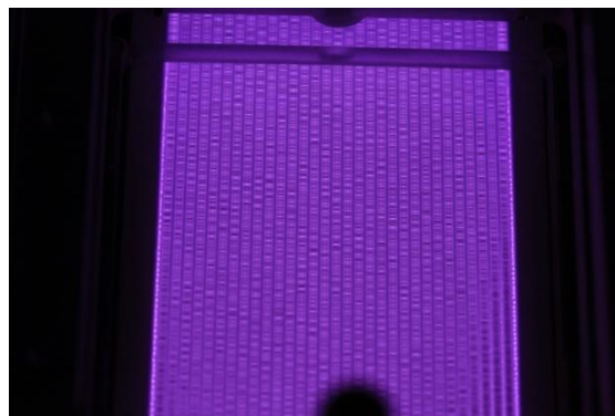
Obr.8: DCSBD výboj s vodivým sklom vo výške z = 0,9 mm pri príkone zdroja 350W.
