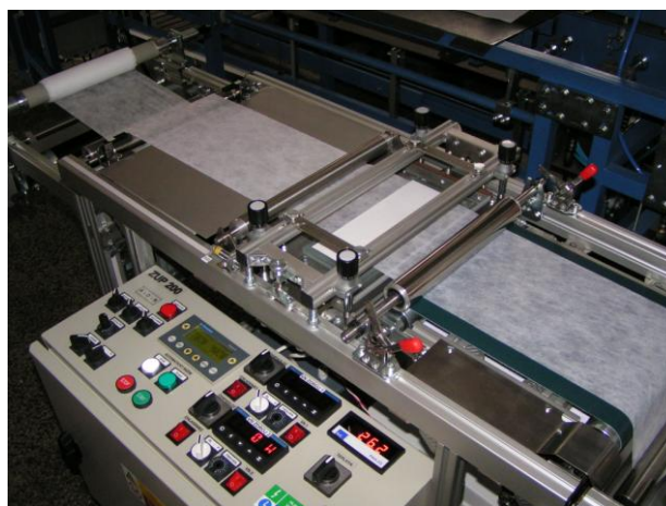
Obr. 1: Plazmové zariadenie ZUP 200. Pohľad na ovládací panel a DCSBD výbojku.
