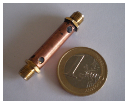
Obrázok 8: Výsledná konštrukcia kompaktného práškového filtra
