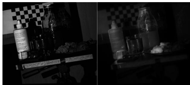
Obrázok 4: Obraz priameho (vľavo) a nepriameho (vpravo) osvetlenia. Zdroj: Autor
